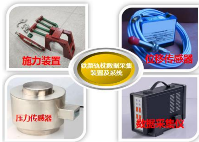
图 4-5 铁路轨枕数据采集装置及系统
